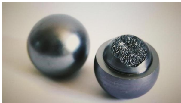
图 6-4 高温气冷堆 TRISO 包覆颗粒球形燃料
