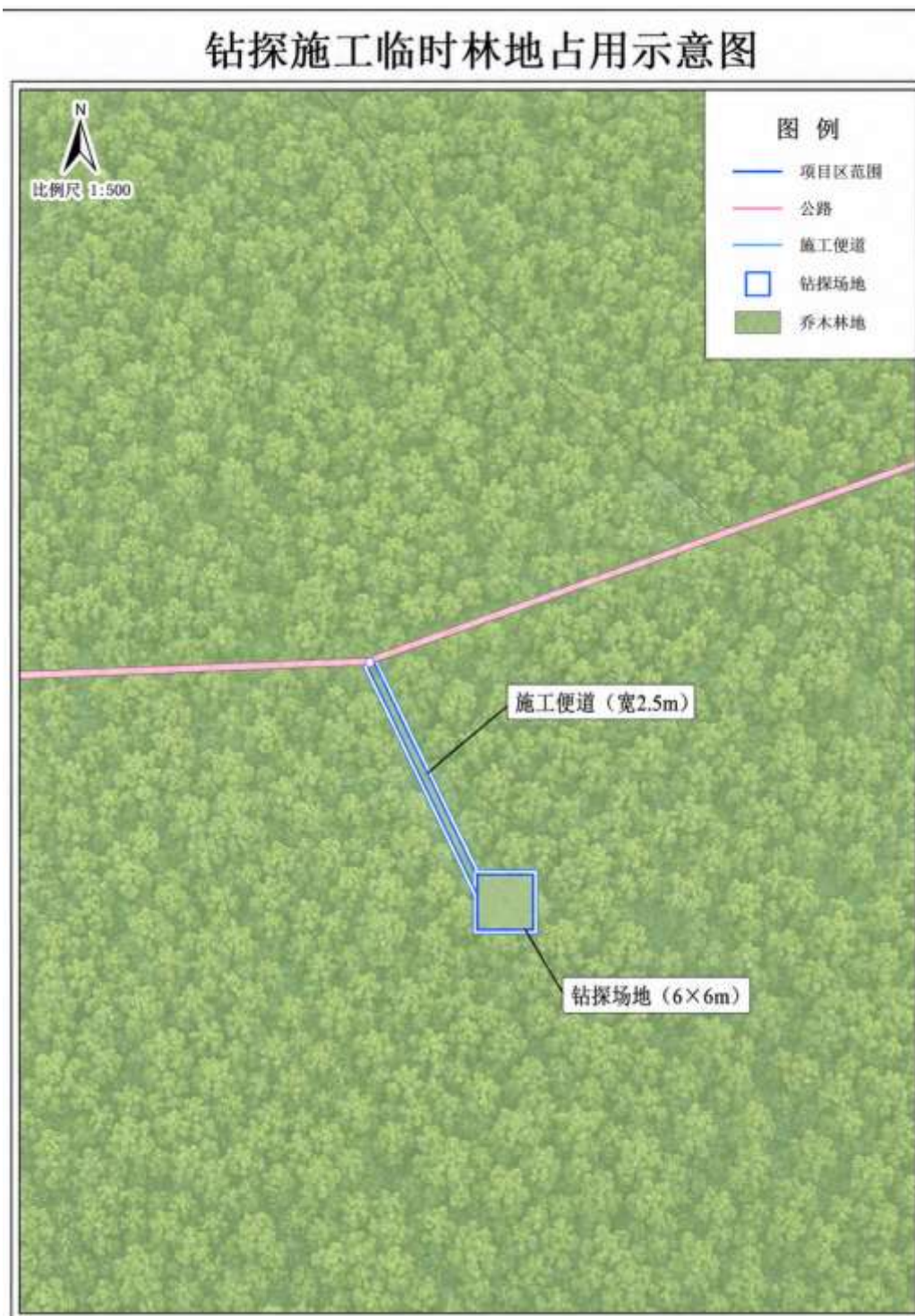
图 4-2 钻探施工临时占地示意图
